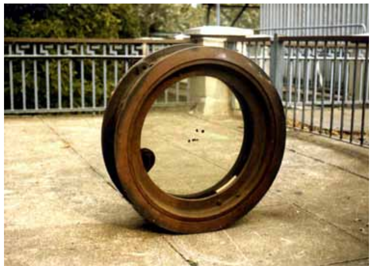
Das 680mm-Objektiv, Brennweite 21 Meter von Steinheil/München (Foto: Nikolai Wünsche)
