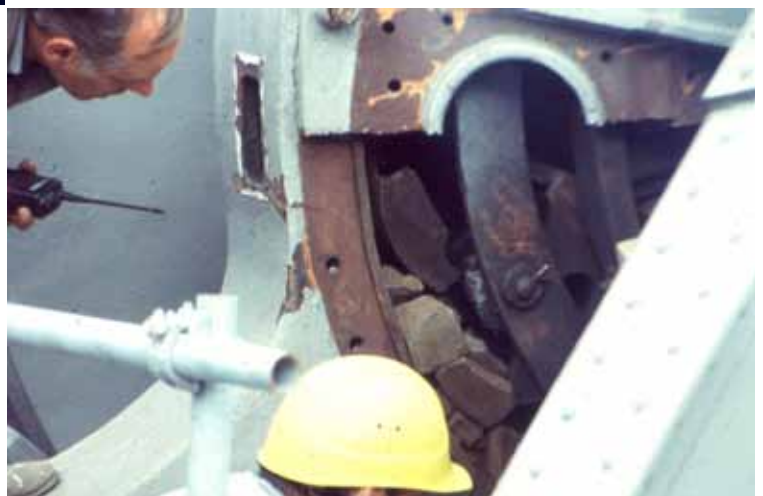
Blick in das zerstörte Deklinationslager (Foto: Nikolai Wünsche)
