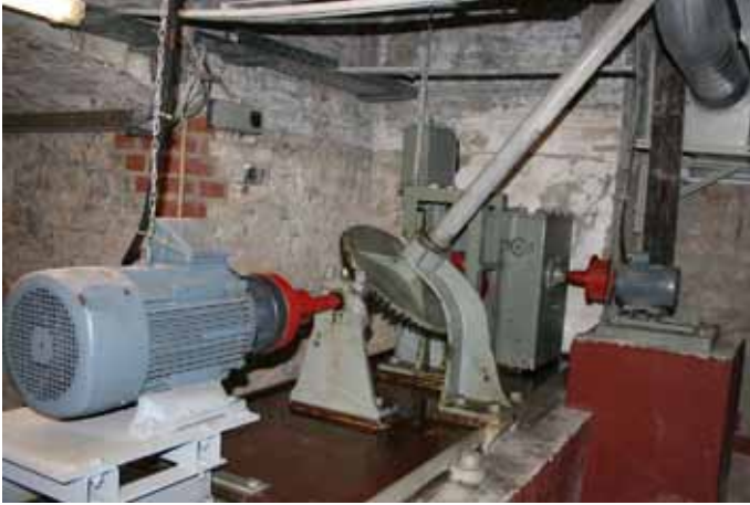
Blick ins Innere des Fundaments. Der Stundenantrieb zum großen Schneckenrad an der äußeren Gabel erfolgt über eine Welle, die Umschaltung zwischen der Grobbewegung (im Bild links der Motor im Vordergrund) und Nachführung (kleine Maschine im Hintergrund) wird elektromagnetisch über eine Kupplung vorgenommen. (Fotos: Eckehard Rothenberg)
