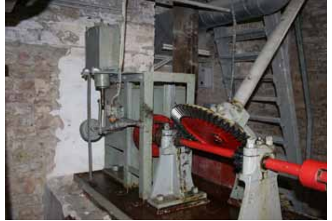
Blick ins Innere des Fundaments. Der Stundenantrieb zum großen Schneckenrad an der äußeren Gabel erfolgt über eine Welle, die Umschaltung zwischen der Grobbewegung (im Bild links der Motor im Vordergrund) und Nachführung (kleine Maschine im Hintergrund) wird elektromagnetisch über eine Kupplung vorgenommen. (Fotos: Eckehard Rothenberg)
